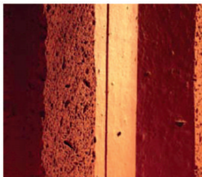
Рис. 6. Поризованная структура черепка
